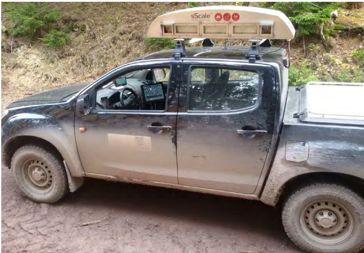
Abbildung 1: Beispiel eines Trägerfahrzeugs von sScale™ , mit auf dem Dach montierter Kameraeinheit und Touchscreen im Beifahrerbereich
