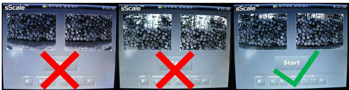
Abbildung 4: zu niedrige, zu hohe und richtige Kameraausrichtung
