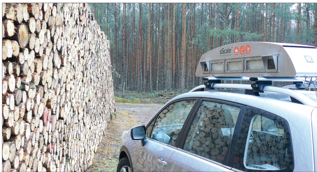
Fotooptisches Stereokamerasystem „S-Scale 3.4“, montiert auf der Dachreling eines Trägerfahrzeuges mit zwei Kameraeinheiten und drei LED-Scheinwerfern vor einem zu vermessenden Industrieholzpolter
