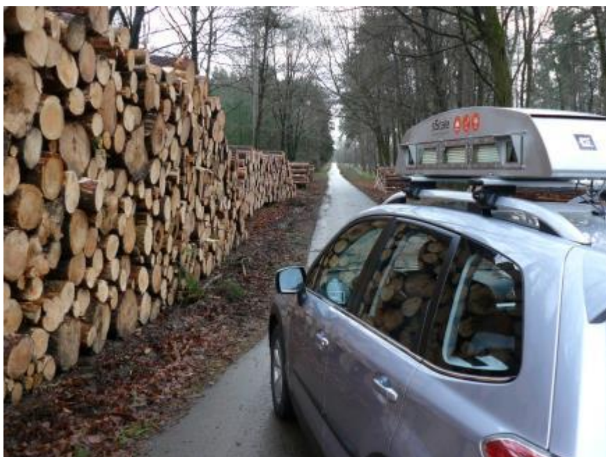
Abbildung 1: Fotooptisches Stereokamerasystem sScale™ 3.4, montiert auf der Dachreling eines Trägerfahrzeuges mit zwei Kameraeinheiten und 3 LED-Scheinwerfern vor einem zu vermessenden Rundholzpolter.
