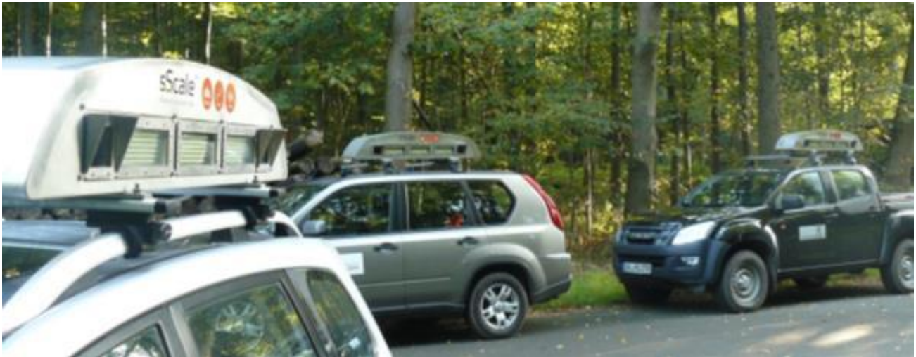
Abbildung 2: Unterschiedliche Trägerfahrzeuge mit dem fotooptischen Stereokamerasystem sScale™ 3.4 bei der Konformitätsbewertung nach Modul G, MessEV, bei der PTB in Braunschweig.
