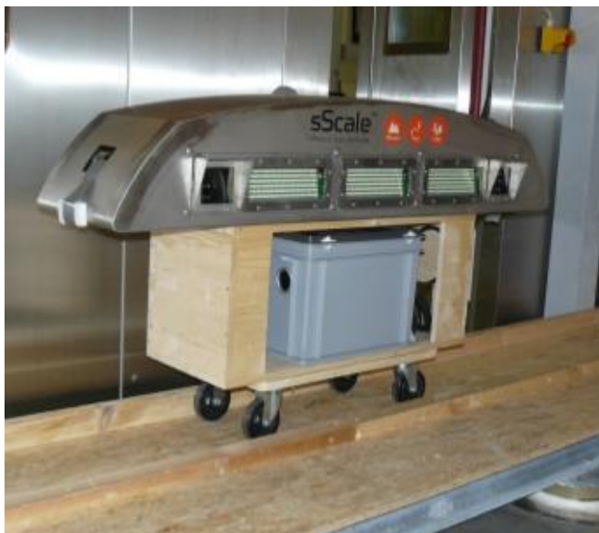
Abbildung 3: sScale™-Gerät auf mobilem Laufwagen in der Klimakammer (links). Darstellung der Flächenmessung mit sScale™ für eine definierte rückgeführte Referenzfläche (Viereck) und der Frontfläche des Poltermodells in der Klimakammer (rechts).
