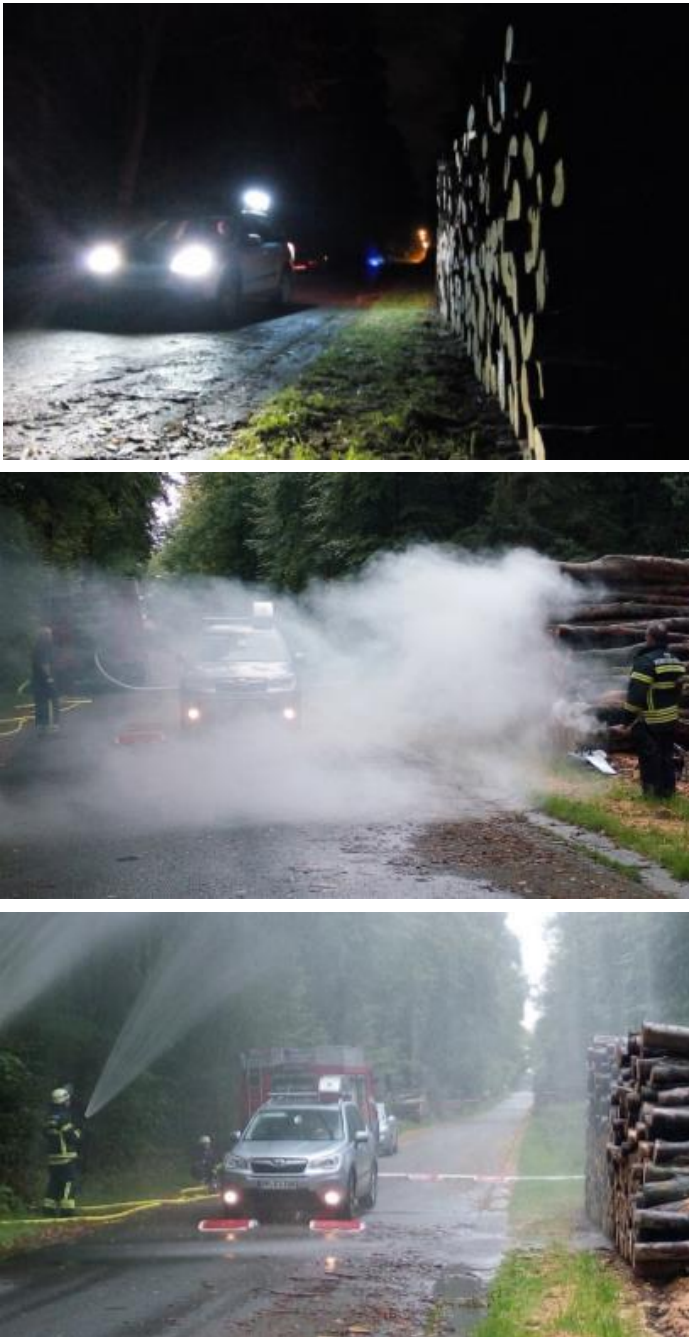
Abbildung 6: unterschiedliche Prüfbedingungen: Nachtmessung (oben), Messung bei eingeschränkter Sicht durch eine Nebelmaschine (mitte), Passieren von Bodenunebenheiten bei starker Beregnung (unten)
